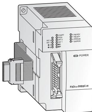
Использование модуля SSCNET III FX3U-20SSC-H в сочетании с ПЛК FX3U – экономически целесообразное решение для высокоточного и высокоскоростного позиционирования. Оптоволоконный кабель типа «plug-and-play» SSCNET уменьшает время установки и увеличивает дальность передачи сигнала управления для операций позиционирования широкого спектра приложений.
