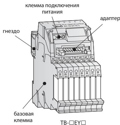
Релейные и транзисторные элементы напрямую подключаются к стандартным клеммам модулей TB-8EY-S и TB-8EY-C. Все элементы снабжены светодиодом индикации состояния, защитой от обратной полярности при подключении и шунтирующим диодом.
